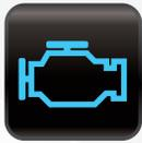
**Anomalie ou vérification du moteur :** Indique que l'ordinateur du moteur a établi un code d'anomalie. Un diagnostic doit généralement être établi au moyen d'un scanner par un professionnel de l'automobile.
