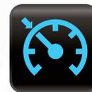
**Régulateur de vitesse :** Indique l'actionnement du régulateur de vitesse durant la conduite.
