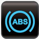
**Système ABS :** Indique que l'ordinateur du système antiblocage a établi un code d'anomalie et qu'un diagnostic doit être établi par un professionnel de l'automobile.
