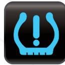
**SSPP (système de surveillance de la pression des pneus) :** Indique que le SSPP a décelé une faible pression d'air dans un pneu ou qu'un capteur SSPP fonctionne mal. Vérifier la pression des pneus. Sur certains véhicules, il est possible de réinitialiser le témoin SSPP, tandis que d'autres nécessitent un diagnostic professionnel. Consulter le guide
