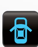
**Portière ouverte :** Indique qu'une portière (y compris le capot et le couvercle de coffre) n'est pas fermée. Ouvrir et fermer toutes les portières, y compris le capot et le couvercle de coffre. Si ce problème n'est pas réglé une fois le moteur éteint, il peut épuiser la batterie.
