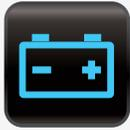
**Batterie/charge :** Indique un niveau de tension sous la normale et un mauvais fonctionnement du système de charge du véhicule. Vérifier les bornes de la batterie, la courroie de l'alternateur ainsi que l'état général de
