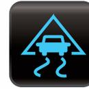
**Antipatinage ou CÉS :** Ce témoin s'allume lorsque le système de contrôle de traction/antipatinage ou le système électronique de la stabilité du véhicule s'actionne. Indique généralement une chaussée glissante.
