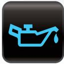
**Pression d'huile moteur :** Si ce témoin reste allumé, il indique une perte de pression de l'huile moteur. Vérifier immédiatement le niveau et la pression d'huile.
