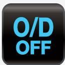
**Surmultiplicateur :** Ce symbole indique que le système de surmultiplication du véhicule a été éteint manuellement. En général, le système de surmultiplication est commandé par un interrupteur
