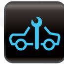
**Entretien du véhicule :** Indique généralement la défaillance d'un feu, d'un phare ou d'un autre accessoire électrique commandé par le module de commande de la carrosserie. Vérifier tous les feux, les phares, les clignotants, les feux d'arrêts et les feux de détresse. Parfois, ce symbole est aussi utilisé pour alerter d'une défaillance du système antipatinage ou d'un problème de communication entre les modules.
