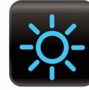
**Feu ou phare brûlé :** Indique un mauvais fonctionnement d'un phare ou d'un feu extérieur du véhicule.
