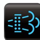
**Filtre à particules d'échappement diesel :** Indique que le filtre à particules d'échappement diesel a échoué son test de validité et qu'il doit être
