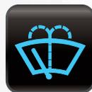
**Liquide lave-glace :** Indique un bas niveau de liquide lave-glace. Remplir le réservoir de lave-glace. Un symbole ressemblant à un pare-brise est apposé sur le bouchon. Certains véhicules sont dotés de deux réservoirs individuels pour le liquide lave-glace du pare-brise et celui de la
