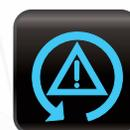
**Anomalie du système antipatinage :** Indique une défaillance du système de contrôle de traction/antipatinage ou du système électronique de la stabilité du véhicule.
