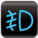
**Phares antibrouillard :** Indique que les phares antibrouillard du véhicule sont allumés.
