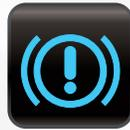
**Système de freinage :** Trois problèmes sont possibles: le frein de stationnement est actionné; défaut du système de freinage ou bas niveau du liquide de frein; ou défaut du système ABS. Vérifier le liquide de frein et s'assurer que le frein de stationnement est
