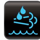
**Fluide d'échappement diesel :** Indique un bas niveau de fluide d'échappement diesel dans le réservoir.
