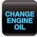
**Rappel de vidange d'huile :** Indique que la durée de vie de l'huile moteur est épuisée. L'huile moteur est surveillée par le module de commande électronique. L'intervalle peut être établi selon le kilométrage ou une combinaison de lectures effectuées par le module de commande. La procédure de réinitialisation du témoin est indiquée dans le guide d'utilisation du véhicule, mais pour certains véhicules, des outils spéciaux doivent être utilisés.
