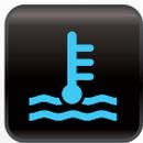
**Température du liquide de refroidissement :** Indique une hausse de la température au-delà de la limite. Vérifier le niveau du liquide de refroidissement, et faire un examen pour déceler toute fuite possible.
