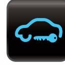
**Alerte de sécurité :** Il indique que le contacteur d'allumage est verrouillé et qu'une clé munie du transpondeur approprié est nécessaire pour faire redémarrer le véhicule. Il indique généralement une défectuosité du système antivol du véhicule.
