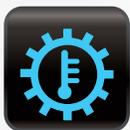
**Température de la transmission :** La transmission fonctionne à une température supérieure à la température optimale. Vérifier le niveau du liquide de transmission et le niveau du liquide de refroidissement
