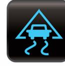
**Control de tracción o ESP:** Se enciende cuando se utiliza el sistema de control de tracción/antideslizamiento o de estabilidad electrónica. En general, es una luz indicadora de que existen condiciones de deslizamiento.
