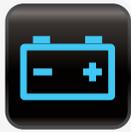
**Alerta de carga/batería:** Indica que el nivel de tensión es inferior al normal y que el sistema de carga del vehículo no está funcionando correctamente. Verifique los terminales de la batería, la correa del alternador y el estado de la batería.
