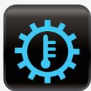
**Temperatura de la transmisión:** La transmisión está funcionando a una temperatura superior a la correcta ya que el líquido de transmisión está más caliente que lo normal. Verifique el nivel del líquido de transmisión y el nivel del refrigerante del motor.
