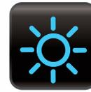
**Lámpara apagada:** Indica que una de las luces externas del vehículo no está funcionando debidamente.
