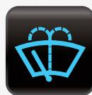
**Recordatorio de líquido limpiaparabrisas:** Indica nivel bajo de líquido limpiaparabrisas. Llene el depósito de líquido limpiaparabrisas. La tapa presenta un símbolo que se parece a una escobilla limpiaparabrisas. Algunos vehículos tienen depósitos distintos para los parabrisas delantero y trasero.
