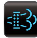
**Luz del filtro de partículas diesel (DPF):** El filtro de partículas de escape en motores diesel no ha pasado la prueba y es necesario realizarle un servicio.
