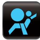
**Falla de la bolsa de aire (airbag):** Si esta luz permanece encendida después del arranque, indica que el vehículo ha detectado una falla en el sistema de bolsa de aire y que la computadora ha enviado un código. Se recomienda la reparación profesional del sistema de restricción
