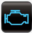
**Luz que indica mal funcionamiento o verificación del motor (MIL):** Indica que la computadora del motor ha enviado un código de diagnóstico de un problema (DTC). En general, requiere un diagnóstico con una herramienta de diagnóstico profesional.
