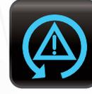
**Falla del ESP:** Indica que se ha producido un problema en el sistema de control de tracción del vehículo/antideslizamiento o estabilidad electrónica.
