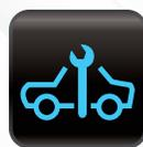
**Se acerca la fecha del próximo servicio:** En general, lo indica una luz u otro problema eléctrico que controla el BCM (Módulo de control de la cabina). Verifique todas las luces, los faros delanteros, las señales de giro, las luces de freno y las luces de peligro. Este símbolo también se utiliza para advertir al conductor sobre un problema en el control de la tracción o un problema de comunicación entre los
