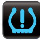
**Sistema de monitoreo de la presión de los neumáticos (TPMS):** Indica que el sistema de monitoreo de la presión de los neumáticos ha detectado que un neumático no tiene la presión de aire suficiente o que un sensor puede estar funcionando en forma incorrecta. Verifica la presión de los neumáticos. Algunos vehículos permiten resetear la luz de advertencia del TPMS y otros requerirán
