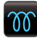
**Bujía incandescente (Diesel):** En los vehículos diesel, esta luz indica que las bujías incandescentes del motor se están calentando y que no se debería encender el motor hasta que esta luz se apague.
