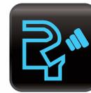
**Tapa de combustible:** La luz de verificación de la tapa del combustible indica que dicha tapa no ha sido debidamente ajustada. Si no se soluciona este problema, a menudo, también se ilumina la luz que indica verificar el motor.
