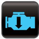
**Advertencia de menor potencia:** Indica que la computadora del motor cuenta con salida limitada de potencia del motor. El módulo ECM cuenta con distintos niveles de potencia reducida dependiendo de cuál es el componente que ha fallado en su
