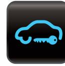
**Alerta de seguridad:** Si el símbolo se ilumina momentáneamente puede significar que el interruptor de encendido se encuentra bloqueado y que necesitará la llave correcta para reiniciarlo. Si el símbolo permanece visible mientras el vehículo se encuentra encendido, entonces, en general, indica un mal funcionamiento del sistema de seguridad.
