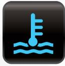
**Advertencia sobre la temperatura del refrigerante:** Indica que la temperatura ha excedido los límites normales. Verifique el nivel del refrigerante, el funcionamiento del ventilador, la tapa del radiador y las pérdidas del refrigerante.
